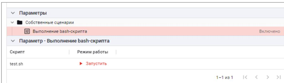
Рисунок 53 – Запуск скрипта вручную
